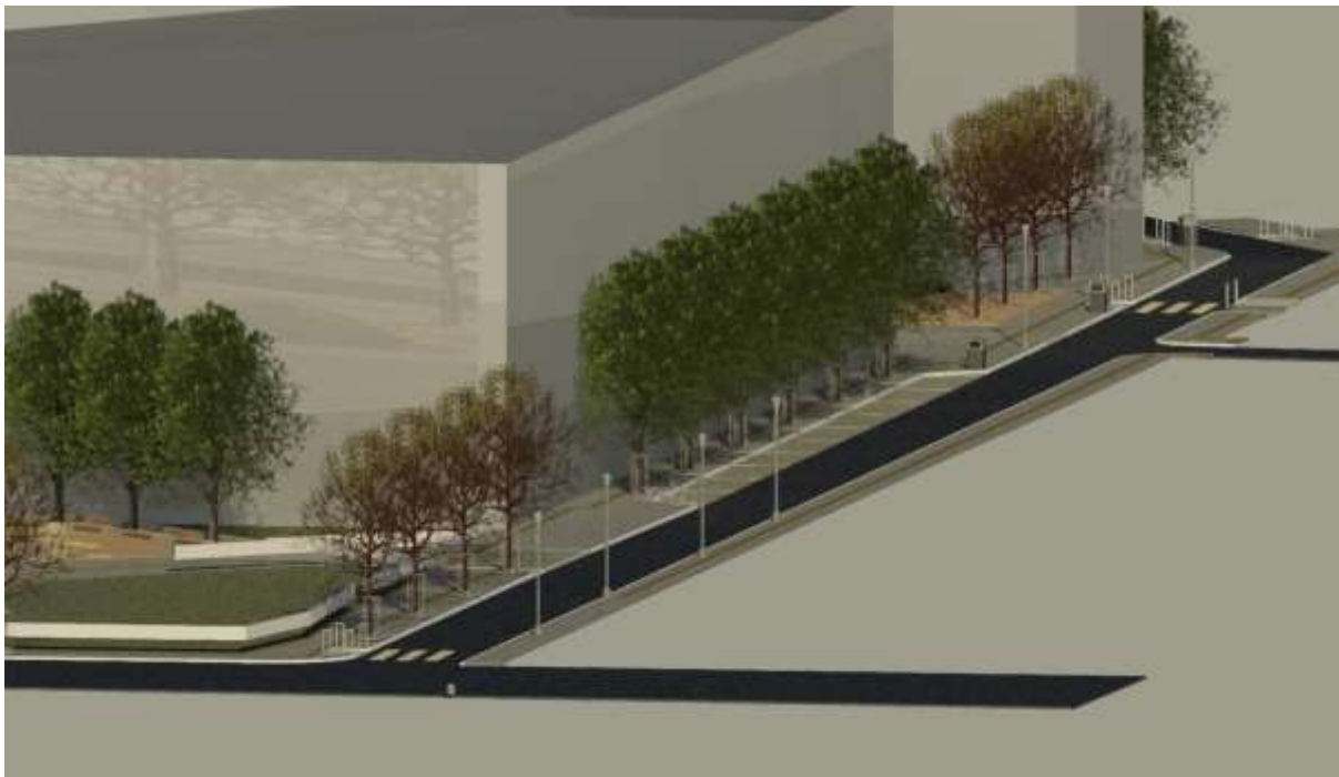
Εικόνα 3. Τμήμα της περιοχής μελέτης σε τρισδιάστατη απεικόνιση όπου διακρίνονται οι διαβάσεις με τις ράμπες και τα προστατευτικά κάγκελα και οι οδηγοί τυφλών
